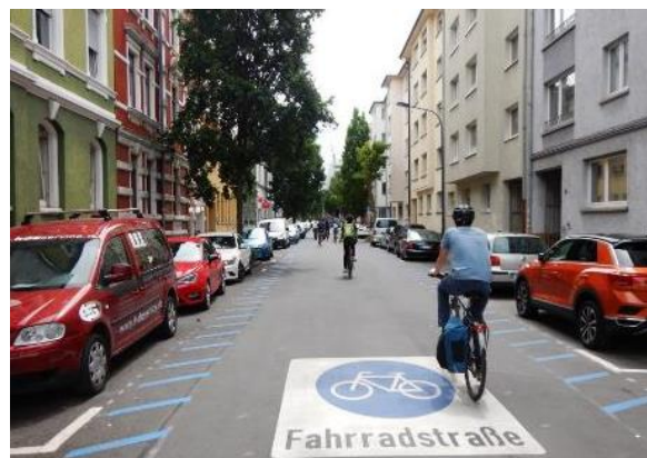
Abbildung 6: Planung Fahrradstraße / eingerichtete Fahrradstraße mit taktilem Sicherheitstrennstreifen zum „Gefahrenbereich Kfz-Türen“ in Offenbach am Main (Quelle: Eigene Darstellung / eigene Fotos)
