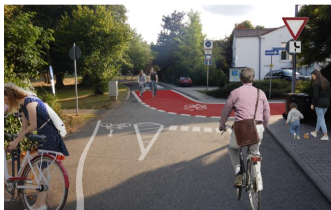
Abbildung 8: Bevorrechtigte Führung des Radverkehrs in der Eichendorff- und Graf-Gerlach-Straße durch Anordnung einer Fahrradstraße (Eigene Bearbeitung)
