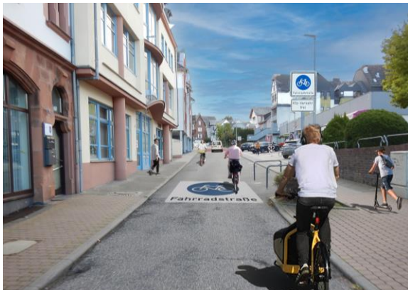
Abbildung 7: Bevorrechtigte Führung des Radverkehrs in der Bahnhofstraße durch Anordnung einer Fahrradstraße (Eigene Bearbeitung)
