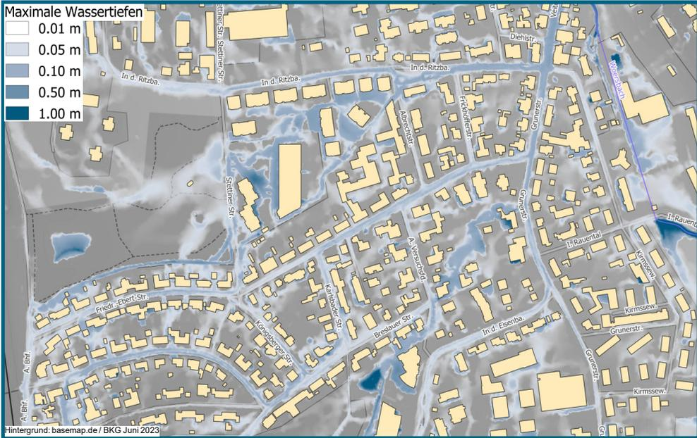
Ausschnitt Starkregengefahrenkarte mit den maximalen berechneten Wassertiefen
