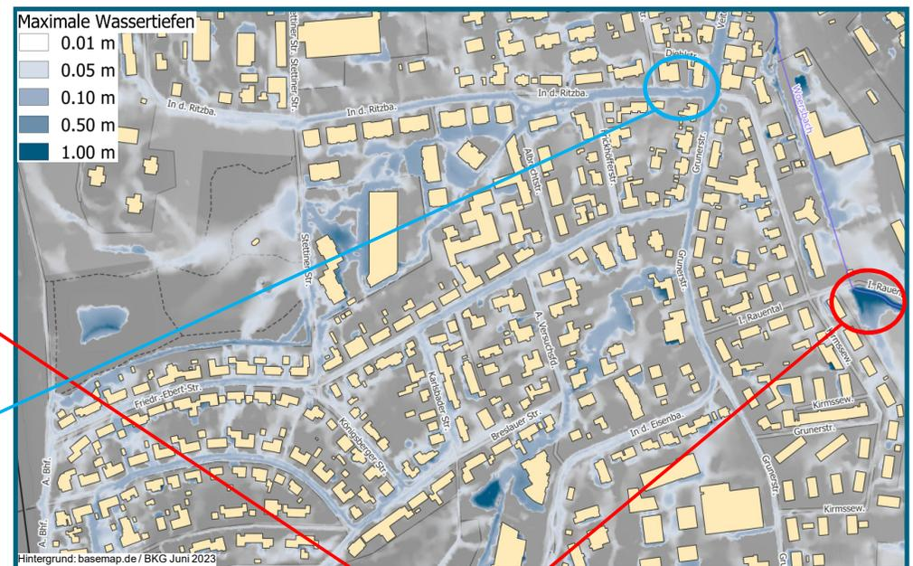
Ausschnitt des Modellnetzes mit den maximalen berechneten Wassertiefen
