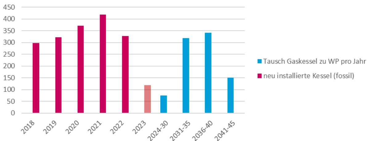
Abbildung 40: Installation neuer Wärmeerzeuger in Idstein in der Vergangenheit (rot) und nach dem maßgeblichen Szenario (blau). Daten zu 2023 sind nicht vollständig (blassrot) (KEEA, 2026)
